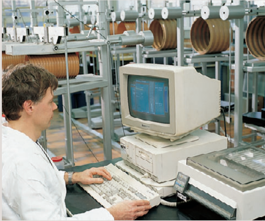
▲ Лаборант Маринус Марсман измеряет степень сжатия трубы при долговременной нагрузке.
